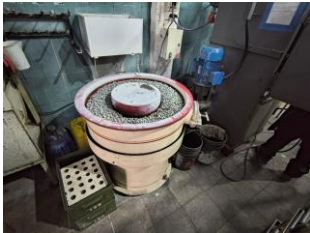
Figura 1: Pulidora industrial vibratoria Vibro 20 lts en planta Bombas NIR.
