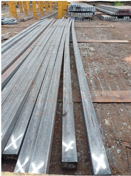
Desviaciones de rectitud en palanquillas SAE 4140
