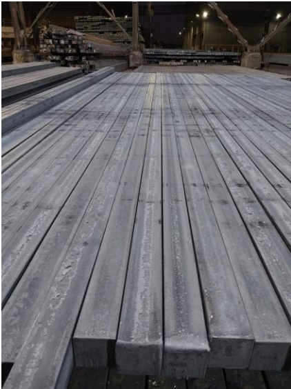
Palanquillas SAE 4140 con rectitude dentro de tolerancia
