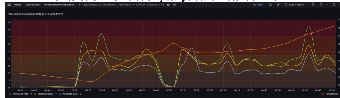
Monitoreo Online vibración y temperatura Motor de Mixer
